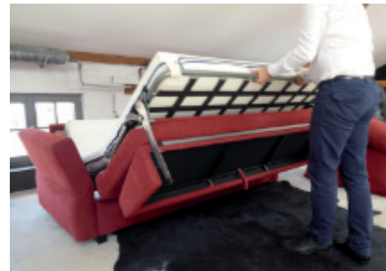
Schritt 4: Bettmechanismus nach vorne ausrollen.
